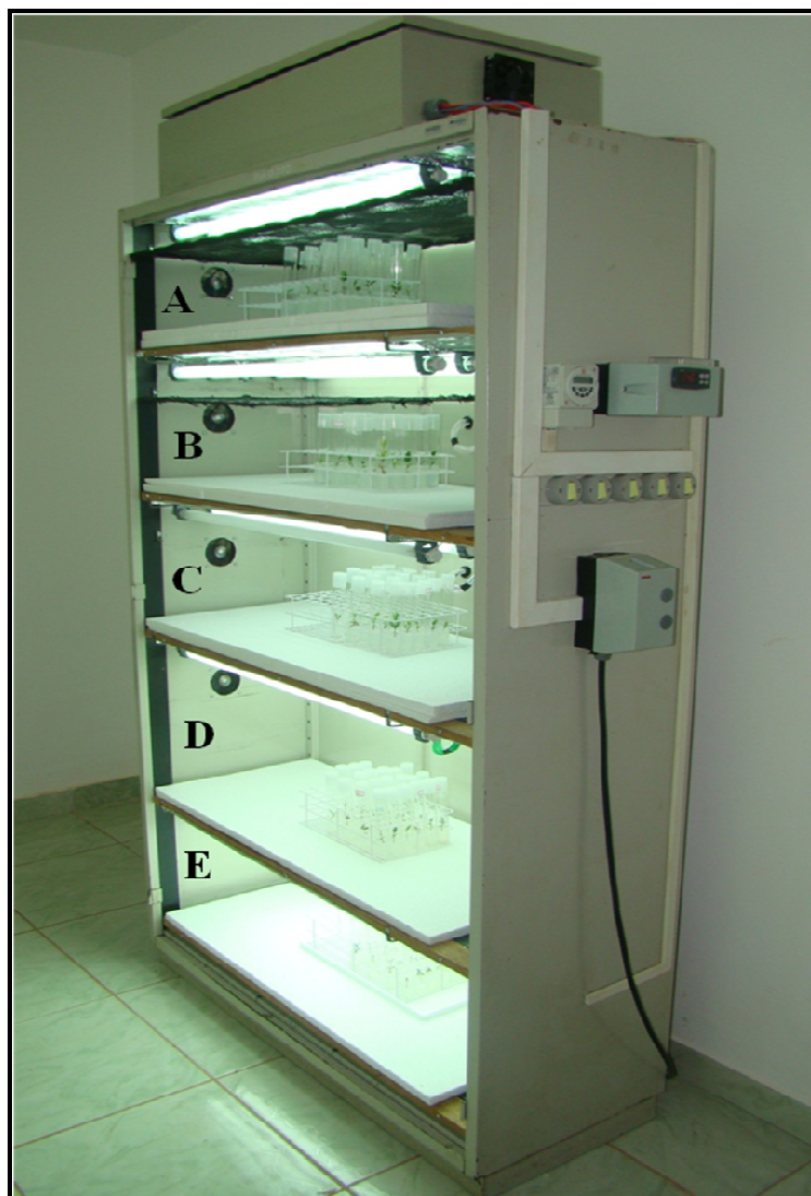
Figura 1. Estrutura utilizada para a imposição dos diferentes níveis de irradiância. Cada prateleira representa um ambiente espectral, 12 \mu\text{mol m}^{-2} \text{s}^{-1} (A); 25 \mu\text{mol m}^{-2} \text{s}^{-1} (B); 50 \mu\text{mol m}^{-2} \text{s}^{-1} (C); 100 \mu\text{mol m}^{-2} \text{s}^{-1} (D) e 150 \mu\text{mol m}^{-2} \text{s}^{-1} (E).
